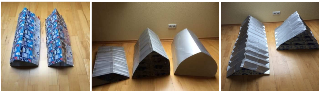
Abb. 12a bis c: Modelle aus Sahnetüten (a) und Milchtüten (b links und Mitte sowie c mit Zickzackfaltung) und ein Modell aus einem Stück Milchtütenfolie 13 (b rechts).
