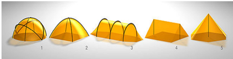
Abb. 2: Geometrie typischer Zelte: Geodät (1), Kuppelzelt (2), Tunnelzelt (3), Firstzelt (4) und Pyramidenzelt (5).
