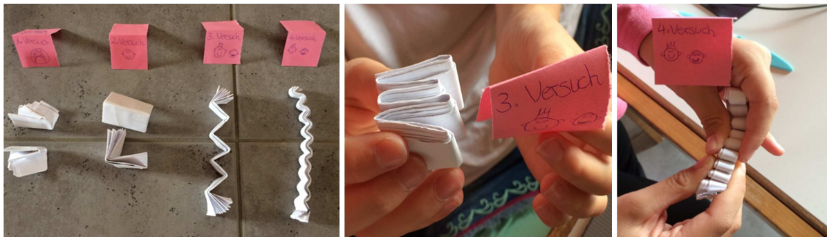
Abb. 5a bis c: Wenn man das Papier zickzackfaltet und die Falten mit einem Messer glatt streicht, kann das Papier besser und kleiner zusammengefaltet werden.
